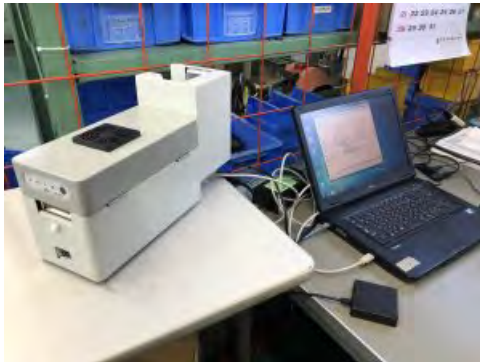
工場内のRFIDリライトカードプリンターと 出入庫管理システムが導入されたパソコン
