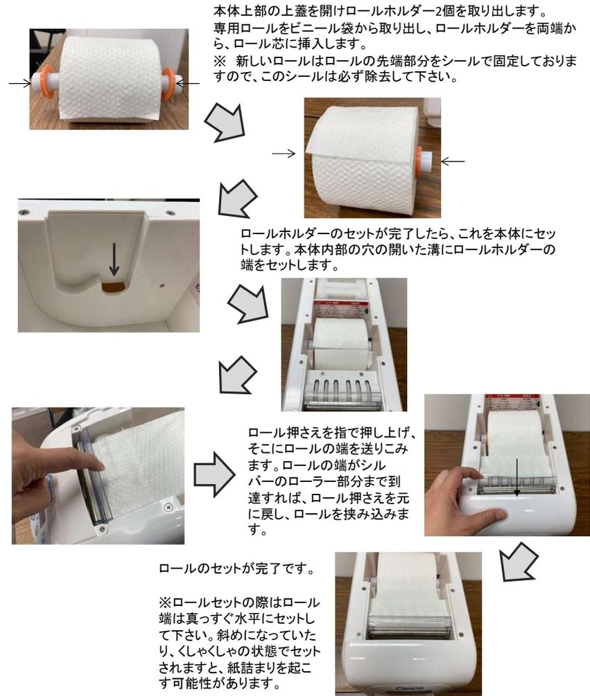
※新たにロールをセットした場合、まず紙送りの動作が入るため、最初にスタートボタンを押した際は、切れ端しか出てきません。2度目以降にスタートボタンを押した再、正常なおしぼりが出てきます。
